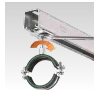
Enroscar el perno roscado en la tuerca soporte MPR y fijar con una tuerca hexagonal. A continuación, montar la abrazadera.
