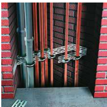
Montaje en bajantes: Conexión por ambos lados del perfil StaboFix® con abrazaderas M8 o M10 para tuberías paralelas
