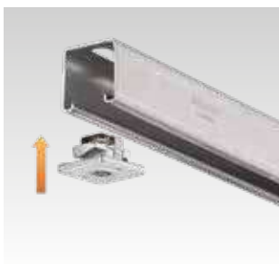
Colocar la tuerca soporte MPR en la ranura del carril.
